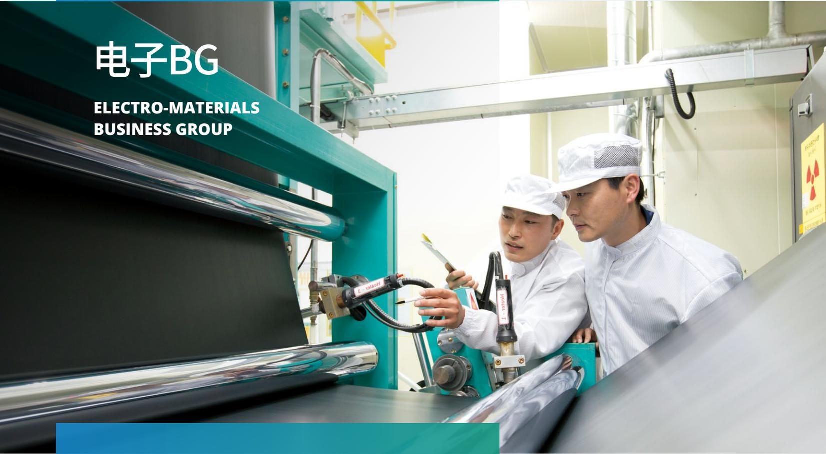
电子BG生产、供应作为电子产品的必需配件使用的印刷电路板(PCB)的核心材料即覆铜箔层压板(Copper Clad Laminate)。本公司的CCL是智能手机、半导体、通信设备等尖端电子设备技术发展的基础。特别是,拥有半导体用PKG CCL、通信设备用NWB CCL、智能手机用FCCL、电气装置用CCL等Hi-end CCL Full Line-up, 作为全球唯一的Supplier,正在不断提高竞争力。
