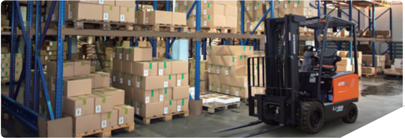
采用锂离子电池的电动平衡重式叉车
